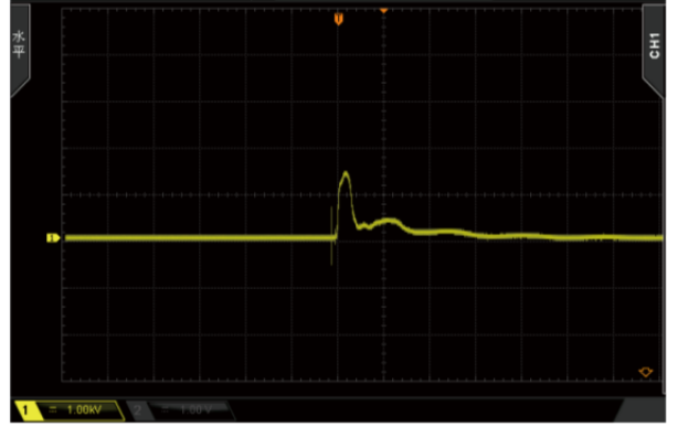
输出端电压波形 (差模 1.3KV)
