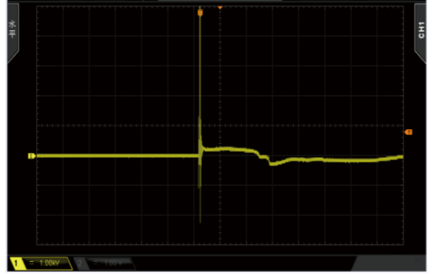
输出端电压波形 (共模 1.3KV)
